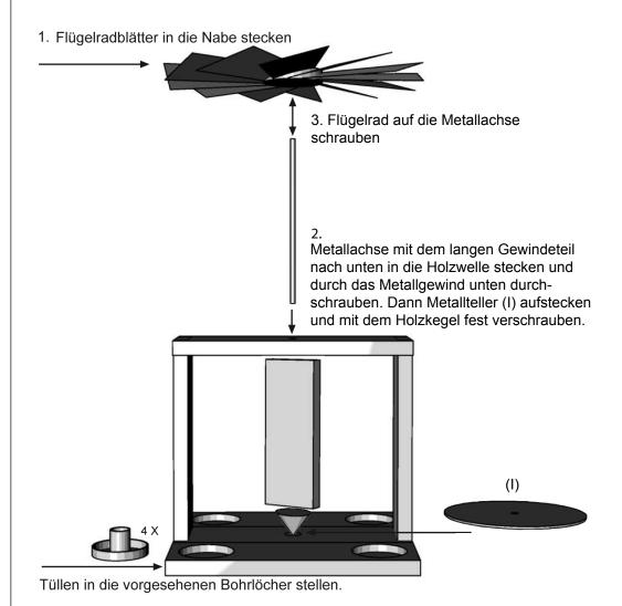
Ihre Pyramide muss um optimal funktionieren zu können genau waagerecht stehen. Etwas Öl in dem Keramiklager erhöht die Laufleistung.
